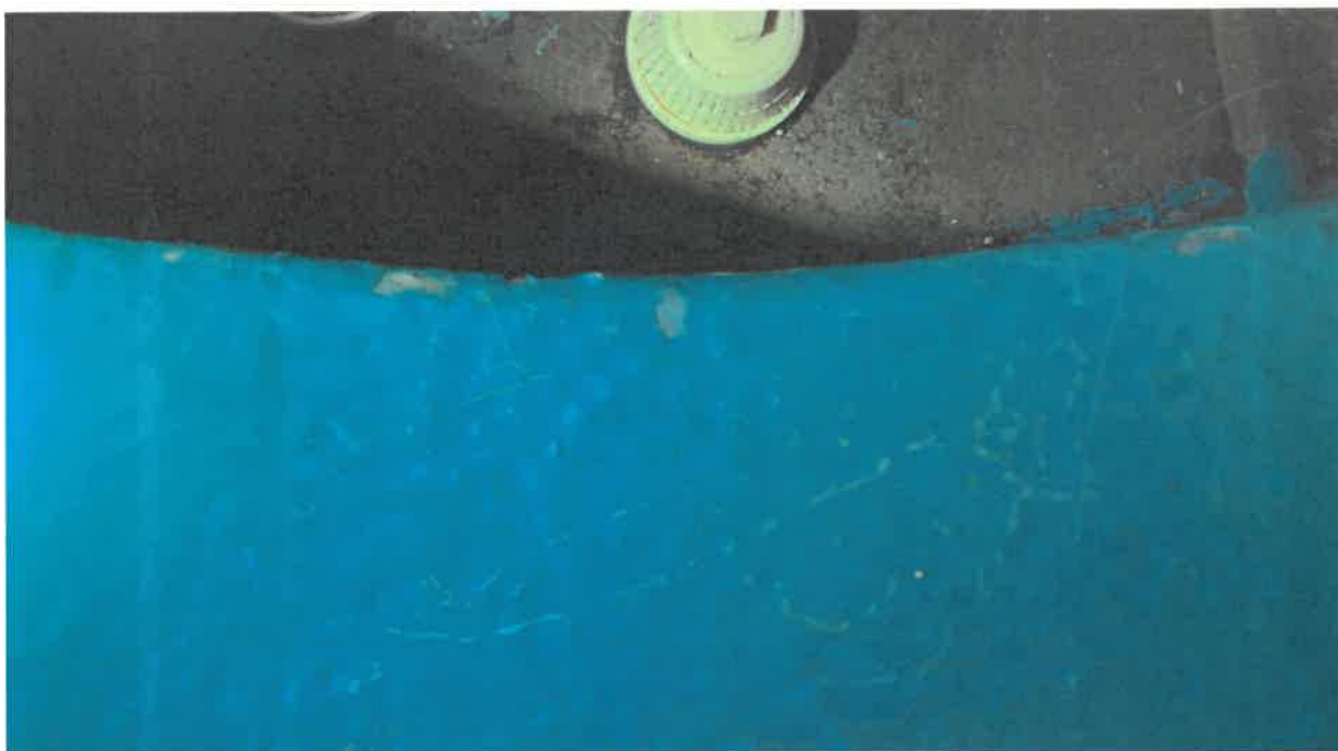
Obr. 8 – Poškození nátěru hrany bočního průlezu.
