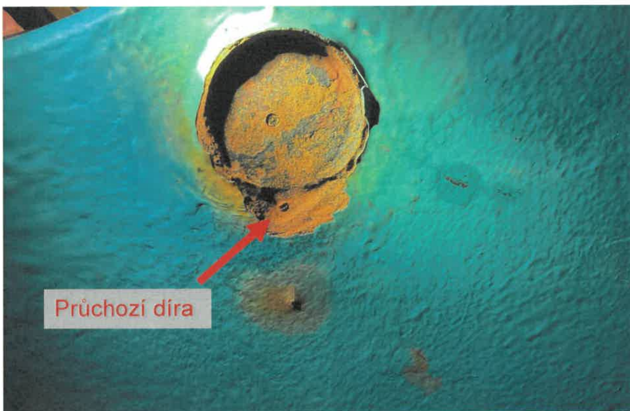
Obr. 1 – Pozůstatek jedné ze vzpěr na horním klenutém dně; červená šipka označuje průchozí díru skrz dno.
