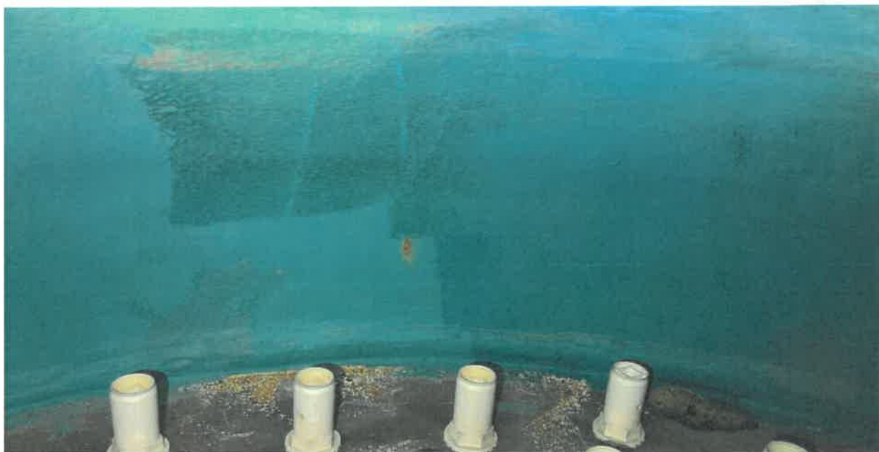
Obr. 5 – Poškození ochranného protikorozičního nátěru na vnitřní straně horního klenutého dna.
